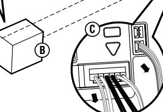
4. Déconnecter de la carte logique (C) les fils provenant des détecteurs inverseurs de sécurité, de la commande et de la serrure de porte et du moniteur de tension du câble.
