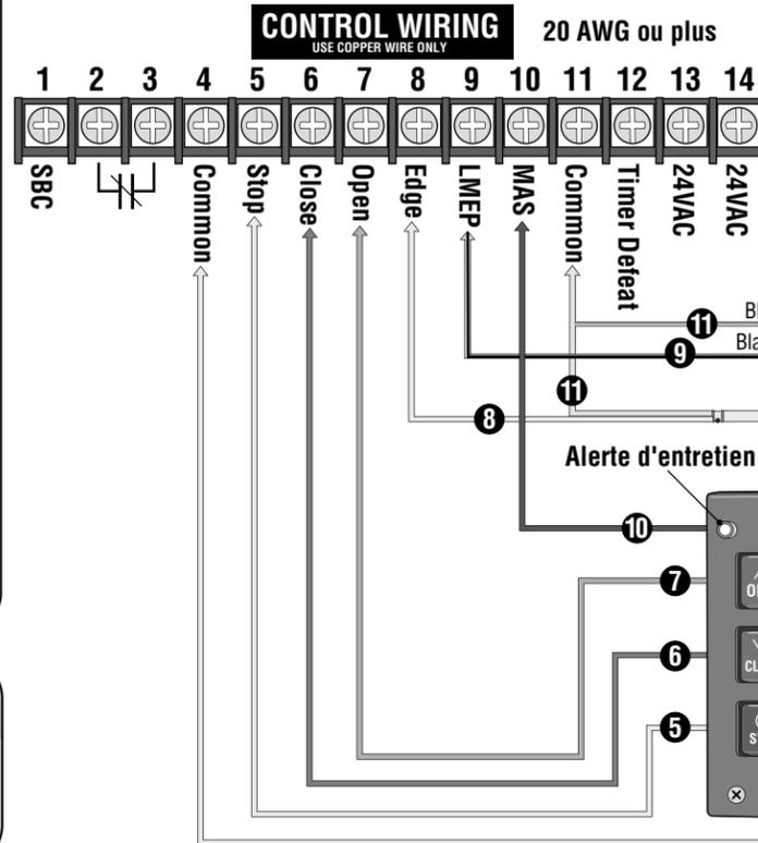
Le dispositif de protection surveillée contre l'emprisonnement de Liftmaster (Liftmaster Monitored Entrapment Protection ou LMEP) est exigé pour la plupart des paramètres programmables. Capteurs photoélectriques Thru-Beam (montrés).
